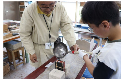
溶かした合金を鑄型に慎重に流し込む
